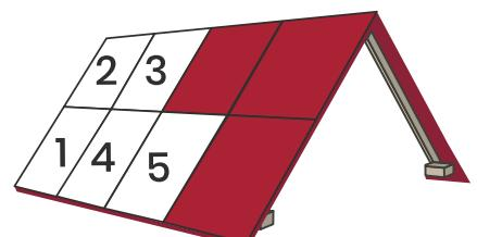
Pravidlem je, aby další tabule byly připevňovány souběžně s linií okapu. Další tabule se pokládají z levé na pravou stranu, v souladu se schématem. U tohoto řešení se po namontování první tabule (bez přišroubování vlny, která překrývá další tabuli) další zasune pod ni kapilární drázkou. Výhodou tohoto způsobu je „zavaknutí“ dalších tabulí, což eliminuje sesouvání tabule dolů. Lze také zvolit způsob montáže zprava doleva. Volba způsobu montáže závisí na pokrývači a jeho zkušenostech.
