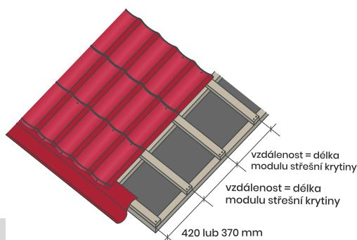
Plechy se nesmí pokládat bezprostředně na lepenku – je bezpodmínečně nutné střechu dříve pokrýt membránou a zhotovit konstrukci z latí a kontralatí.
